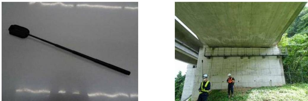
図3 360度カメラ（左）および使用状況（右）
