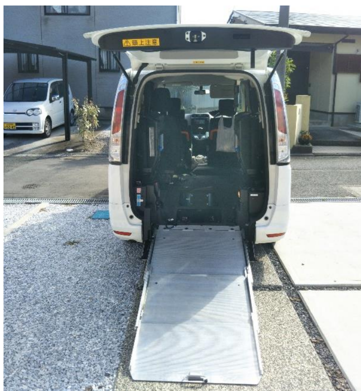
車輛乗降部 (背面スロープ)
