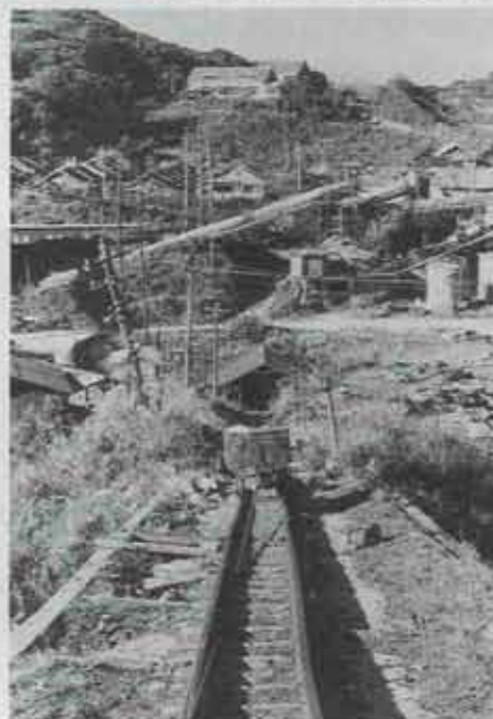
② 坑内から作業材料や不用品を巻き上げている炭車。遠くに見えるのは選炭水洗機
