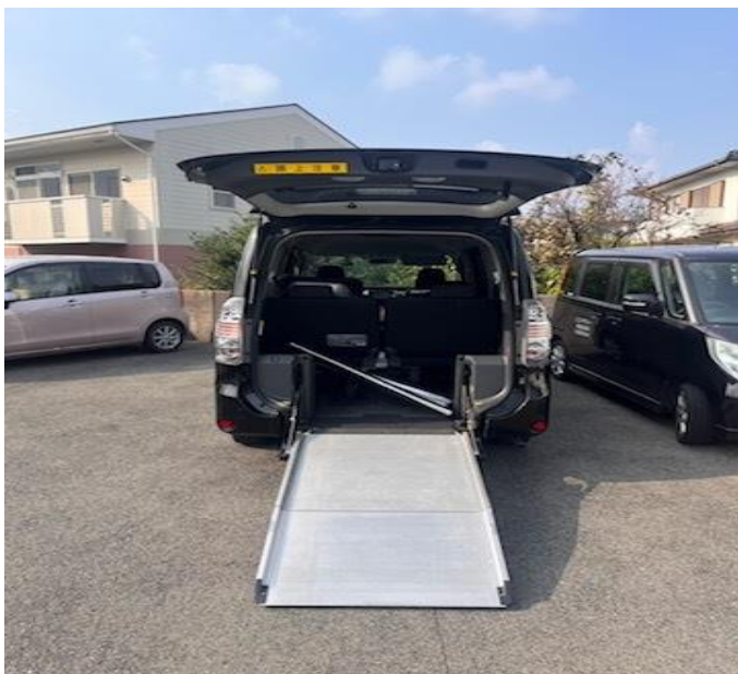
車輛乗降部（背面スロープ）
