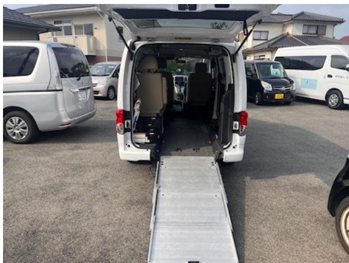
車輛乗降部（背面スロープ）
