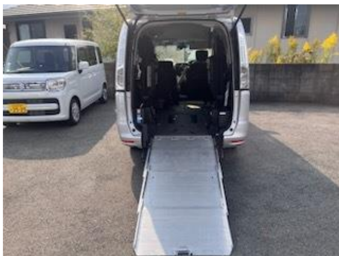
車輛乗降部（背面スロープ）
